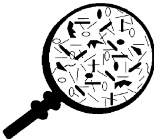
Figura 4. Composición del petróleo a nivel microscópico. Las líneas rectas y curvas representan las moléculas de parafina, las elipses sólidas representan las moléculas aromáticas, las elipses huecas las moléculas de resinas y las formas sólidas representan las moléculas de asfaltenos.
