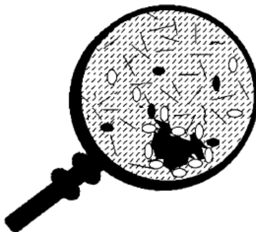
Figura 7. Fenómeno estérico coloidal debido al incremento en la concentración de parafinas
