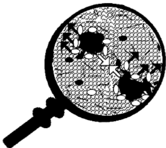
Figura 8. Migración de resinas de la superficie de los asfaltenos debido a la diferencia del potencial químico entre el seno del crudo y la superficie de las partículas. Esto origina un potencial de agregación entre los asfaltenos.
