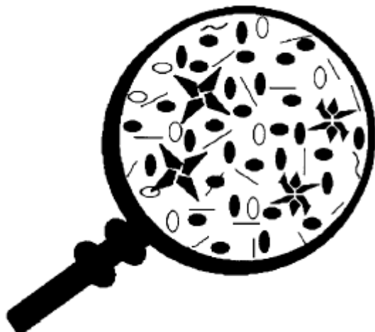
Figura 5. Fenómeno de agregación coloidal debido al incremento en la concentración de un solvente polar miscible (aromático).
