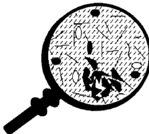
Figura 6. Floculación y precipitación de asfaltenos debido a la adición de un solvente miscible no polar (parafina).
