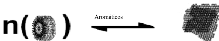
Figura 13. Coacervación de micelas de asfaltenos debido al incremento en la concentración en solventes aromáticos [14].
